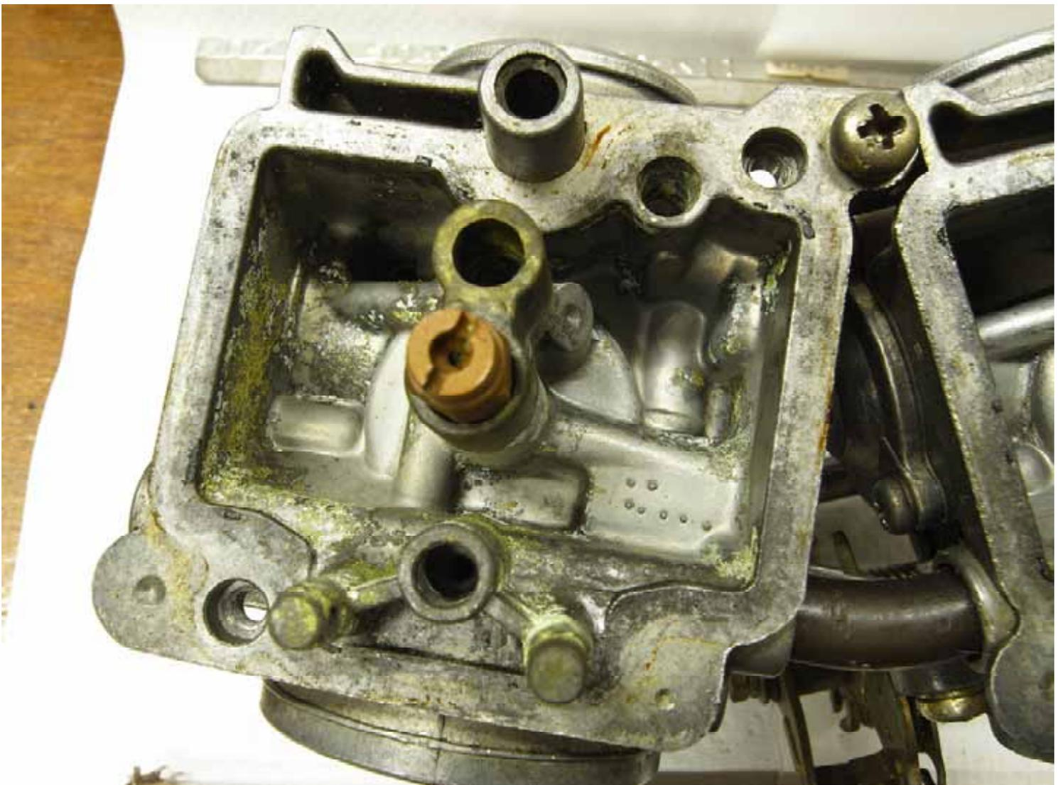
Und das ist der Grund für die Ständige Verschmutzung der Düsen und Bohrungen .
