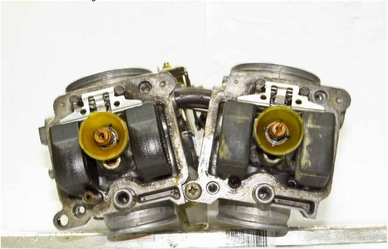
Die Schwimmerkammerdeckel sind bei den Vergasern der R gleich . Die eingepreßte Düse am Boden des Primären Vergaserdeckels wie bei den RM/LM Modellen gibts hier nicht .
