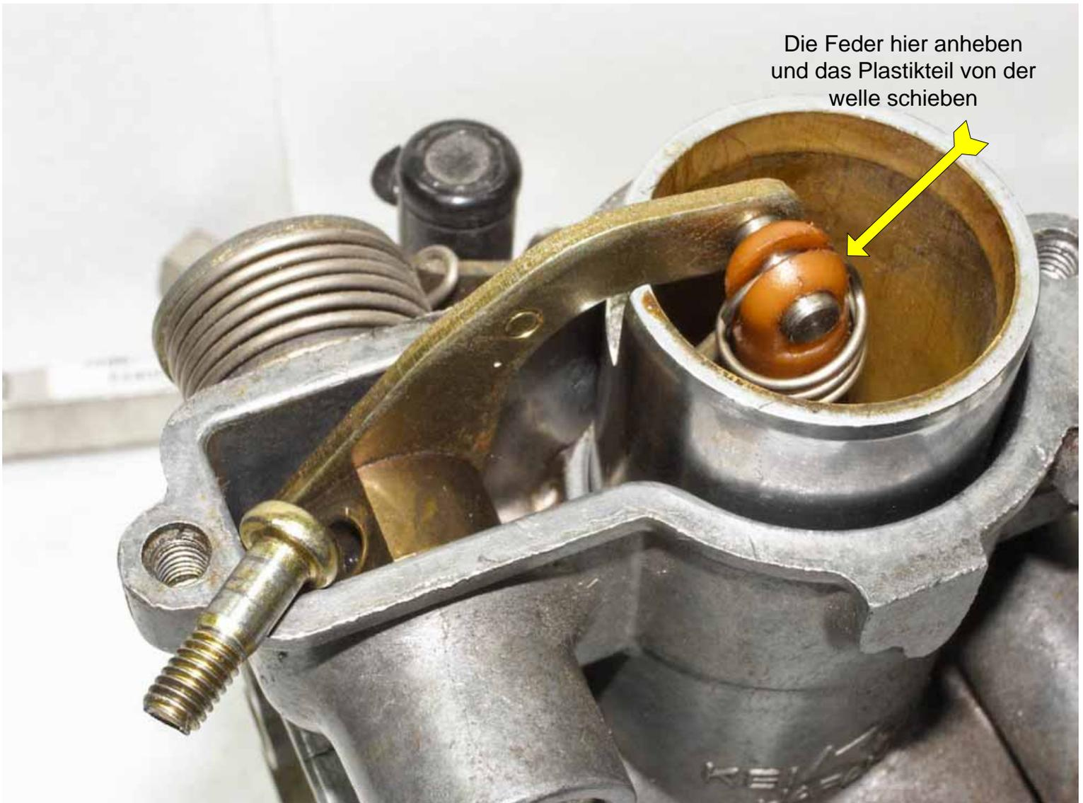
So die Schraube ist raus . Gut auf die Schraube aufpassen , die sieht mir nicht so aus als wenn man die bei jedem Schraubenhändler bekommt , und der Hebel muß spielfrei auf der Welle sitzen . Der Schieber ist angehoben und von unten mit irgendwas unterbaut damit er nicht runter fällt . Jetzt die kleine Feder etwas anheben und das Plastikteil im Schieber von der Welle schieben . Ist der Hebel gelöst kann er weg geklappt werden und der Schieber kann aus dem Vergaser gezogen werden .
