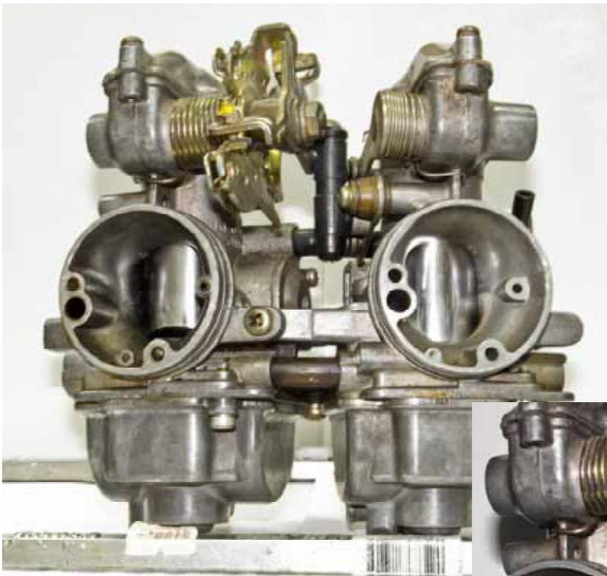
Jetzt mal zu der versetzten öffnung der beiden Vergaser durch die seltsame Verbindung und das ominöse Tupfhebelspiel . Links noch mal ein Foto Der Vergaser bei Standgas . Sec. Vergaser komplett geschlossen .
