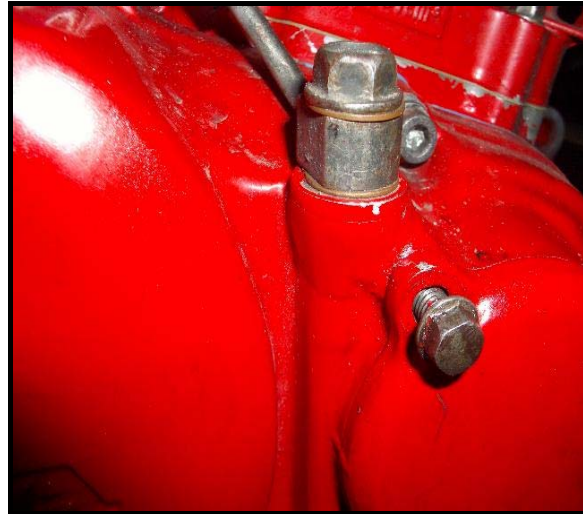
Gut zu erkennen der Riss im Seitendeckel
