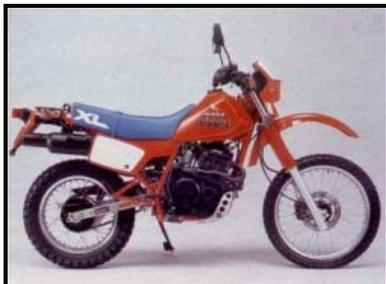
Anfang 1985 wurde das Design der XL-Modelle geändert, außerdem kam wieder eine Version mit 350ccm auf den Markt. Die Tauglichkeit für den Sozusbetrieb wurde durch eine separate Fußrastenbefestigung am Rahmen deutlich verbessert.
