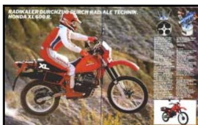
Bereits 1983 erfolgte die Vorstellung Ihrer großen Schwester, der XL600R. Die Honda-Techniker konstruierten den völlig neuen, sehr aufwendigen RFVC-Motor, in dem die vier Ventile radial angeordnet sind, um eine möglichst optimale halbkugelförmige Brennkammer zu schaffen. Neu waren auch das Zweivergasersystem, das Dekompressionsventil zur Erleichterung des Starts und die vordere Scheibenbremse. Das gesamte Fahrwerk wurde optimiert und verstärkt.
