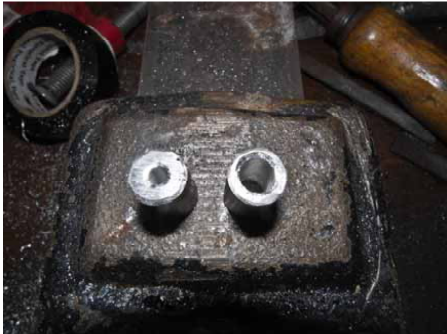
Links 3 mm was der Ölleitung zum Getriebe entspricht und rechts 5,4 mm das ist in etwa die Größe der Blende die hinter der Pumpe in der Leitung hoch zum Rahmentank sitzt .
