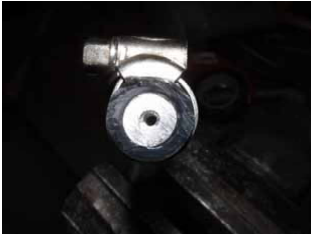
2,16 mm was die Bohrung in der oberen Schraube der Steigleitung am Zylinderkopf simulieren soll
