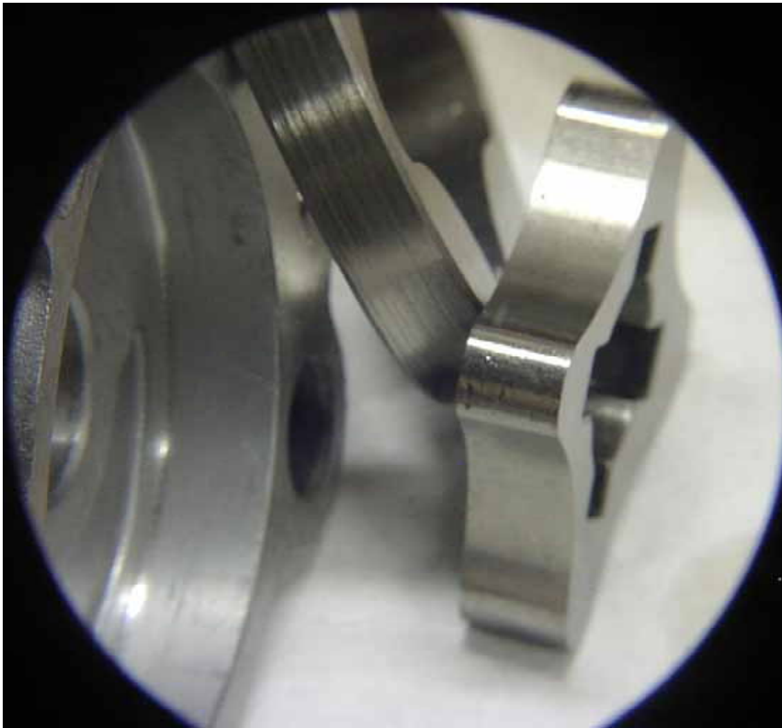
Rotor A die seitlichen Dichtflächen . Das sind die Seiten mit den meisten Laufspuren
