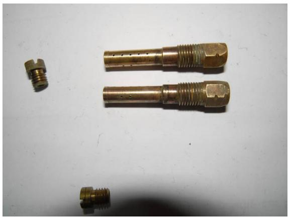
Hier noch mal die saubergemachten Düsenstöcke mit einer Kerbe für den Primären und 2 Kerben für den Sekundären Vergaser, denn ob die längsbohrung in der die Nadel sitzt gleich ist weiß ich nicht.
