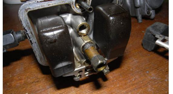
Und was mir beim fotographieren aufgefallen ist, die Schwimmer und die Schwimmernadel sowie der Pin sind bei PE und PD Vergasern absolut gleich. Keihin bedient sich also auch aus dem großen Baukasten. Außerdem sieht man das , das Alu des bestimmt 10 Jahre alten PE Vergasers der seit
