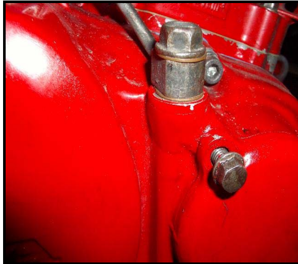
Gut zu erkennen der Riss im Seitendeckel
